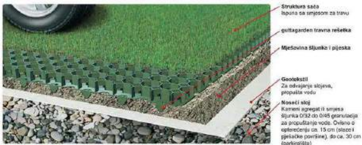
Fotografija: Način postavljanja travne rešetke Gutta
