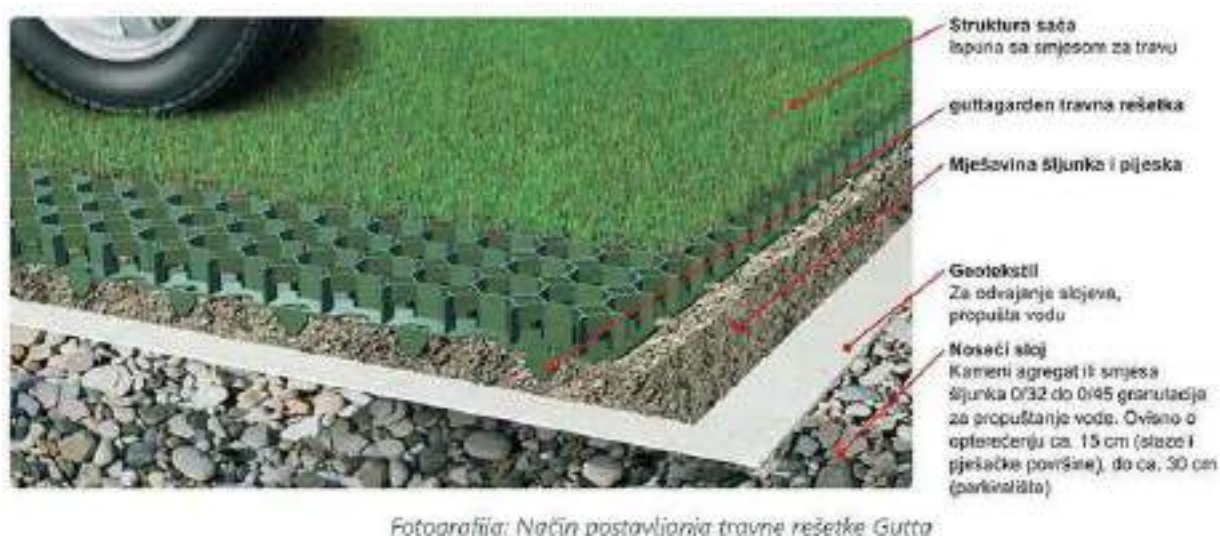
Слика 6. Графички приказ - начин постављања „травне решетке“ Гутта
